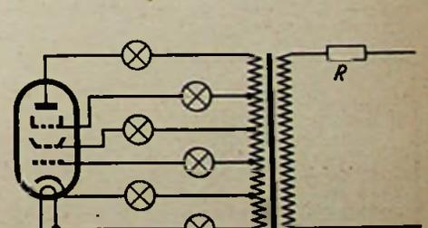
Bild 3. Elektrodenschlußprüfer mit direkter Anzeige
