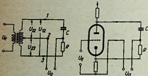
Bild 2. Prinzip der Phasenbrücke
