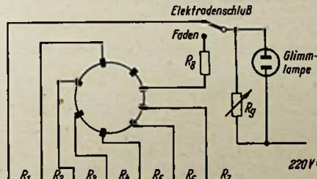
Bild 2. Einfacher Elektrodenschlußprüfer
