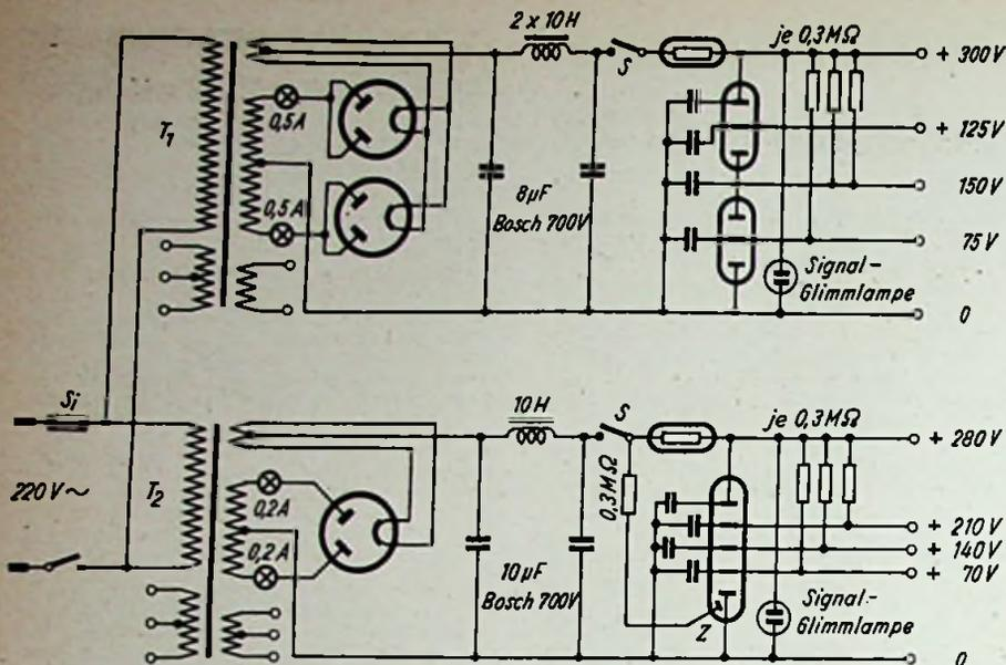
Schaltung D. Dieses Gleichrichtergerät liefert stabilisierte Spannungen bis +300 V, 200 mA und bis +280 V, 120 mA. Transformator  $T_1 = 2 \times 500$  V, 350 mA, Transformator  $T_2 = 2 \times 500$  V, 160 mA. Gleichrichterrohren: RGN 2504, Stabilisatoren: 2 x STV 150/250 und STV 280/150 Z. Die Bezeichnung Z besagt, daß der Stabilisator eine eigene Zündstrecke besitzt
