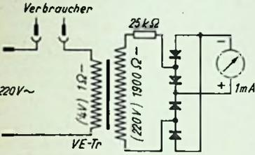
Schaltung des Wechselstrom-Wattmeters
