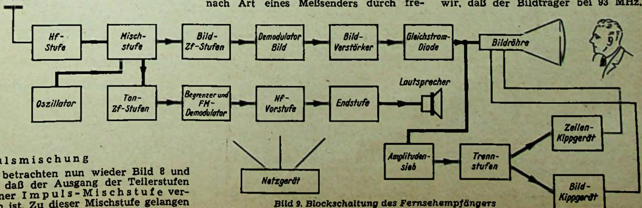
Bild 9. Blockschaltung des Fernsehempfängers
