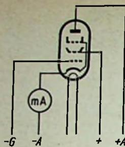
Bild 8. Röhrenprüfung mit einem Instrument in der Katodenleitung
