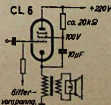
Bild 9. Ausgangsübertrager in der Katodenleitung, Röhre in Katodenschaltung
