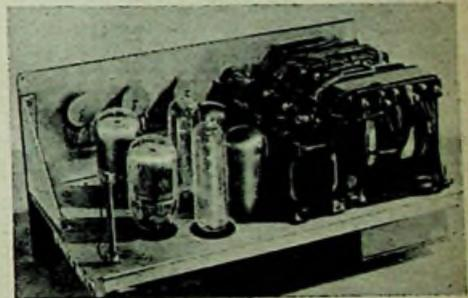
Rückansicht des Gleichrichters nach Schaltung C
