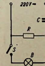
Rechts: Bild 7. Schaltung mit Sicherung gegen Einschaltstoß und Netzstörungen. Schalter entweder S<sub>1</sub> oder S<sub>2</sub>
