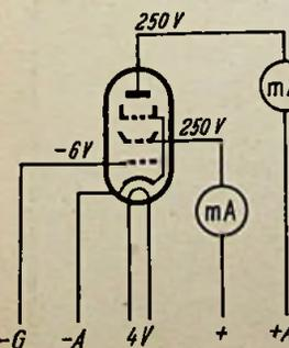
Bild 4. Strommessungen (AL 4)
