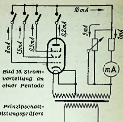
Bild 10. Stromverteilung an einer Pentode
