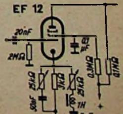
Bild 10. Schaltung zur Regelung des Frequenzganges durch Hoch- und Tieftonglieder
