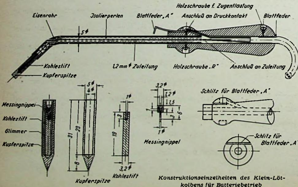
Konstruktionseinzelheiten des Klein-LötKolbens für Batteriebetrieb
