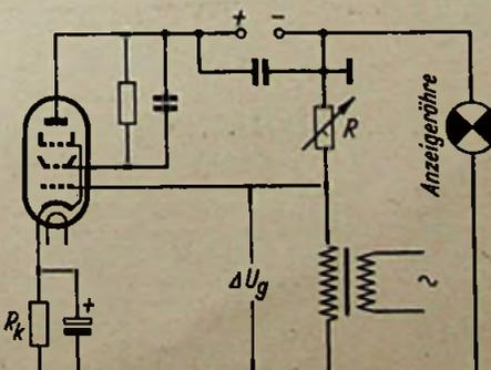
Bild 6. Prüfung der Steilheit nach Barkhausen
