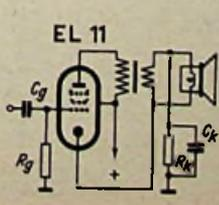
Bild 7. Gegenkopplung in der Katodenleitung der Endstufe
