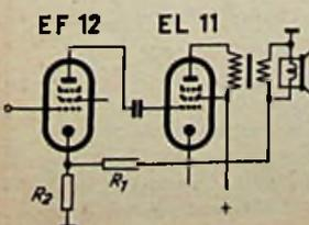
Bild 6. Einfache Gegenkopplungsanordnung
