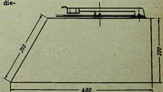
Gehäuseansicht, von der Seite gesehen. Der Plattenspieler ist auf der oberen Gehäuseplatte eingebaut
