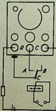
Bild 2. Anschluß des Relais an eine Meßbrücke
