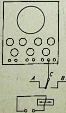
Bild 3. Anschlußschema des polarisierten Relais am Oszillografen
