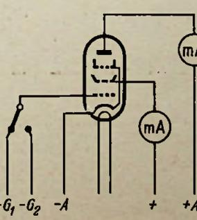
Bild 5. Messung des Anodenstromes bei verschiedenen Gitterspannungen
