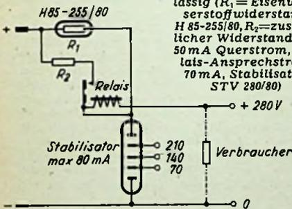
Schaltung B. Entnahme der Röhrenheizung über die Strecke 0...-70V
